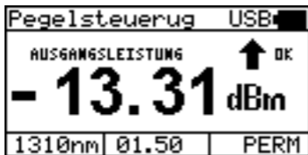
Bild 9 Beispiel: Messanzeige in der Betriebsart „Pegelregler“
